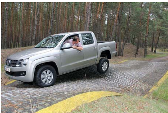
F23: Wenn zwei Räder diagonal den Bodenkontakt verlieren, wird die Traktionskontrolle ratlos.
