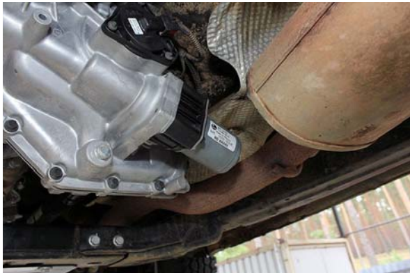
F21: Der Stellmotor des Verteilergetriebes lugt nach unten heraus.
