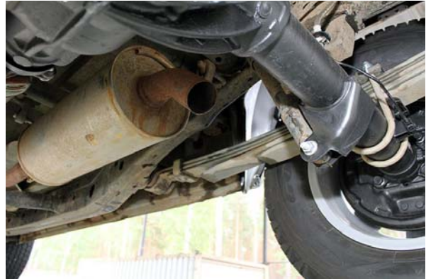
F20: Der Auspuff endet vor der Hinterachse, gut geschützt, im Wasser aber nicht optimal.
