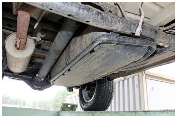
F18: Der Tank wird von einer Rohr-/Blech-Ummantelung geschützt.
