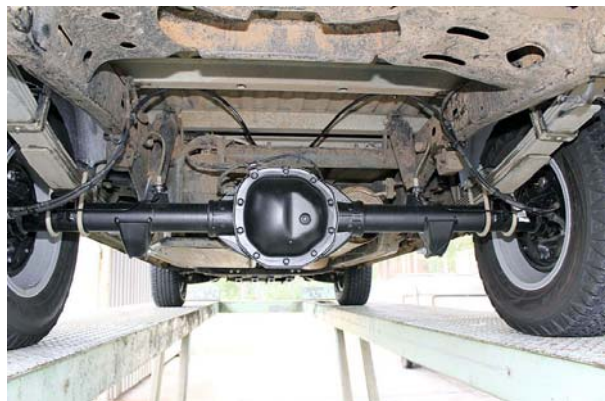
F16: Das Hinterachs-Differential ist der tiefste Punkt unter dem Auto.
