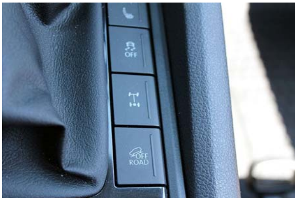
F11: Per Knopfdruck wird die hintere Sperre aktiviert und (im Straßenallrad) der Offroad-Modus scharf geschaltet. In der Untersetzung ist er automatisch dabei.
