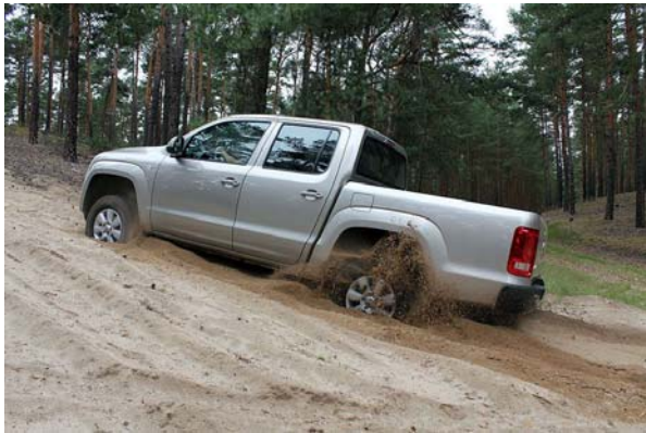
F27: Anfahren im tiefen Untergrund stellt ihn vor echte Probleme, die Traktionskontrolle arbeitet hier nicht zufriedenstellend.
