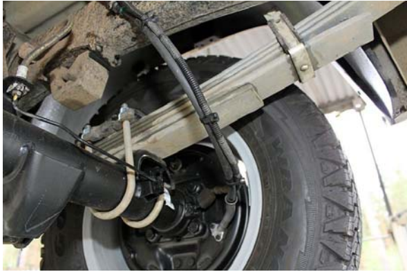
F19: Vorsicht bei Rückwärtsfahrt im Wald: Äste könnten in die frei hängenden Handbrems- und ABS-Leitungen einfädeln.
