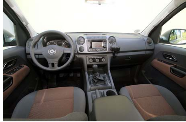
F14: So sieht ein Amarok aus, wenn er für ernsthafte Anwendung gerüstet ist. Robuste Stoffsitze statt Leder, Kunststoff-Boden- und Lenkrad.
