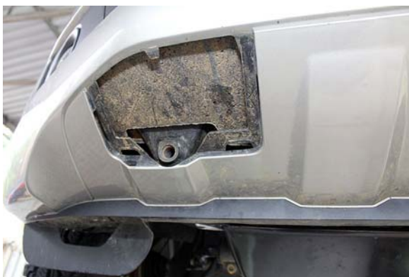
F17: Vorne und hinten gibt es nur Einschraub-Schleppösen, das ist für einen echten Geländewagen unwürdig und im harten Einsatz indiskutabel. Eigenbau tut Not.
