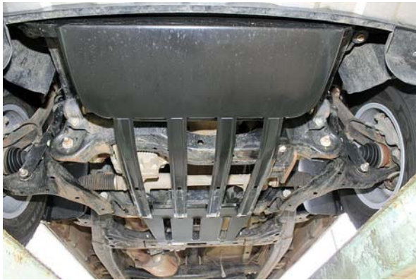
F9: Der Unterfahrschutz ist sehr stabil und lässt trotzdem Luft an Motor und Getriebe.
