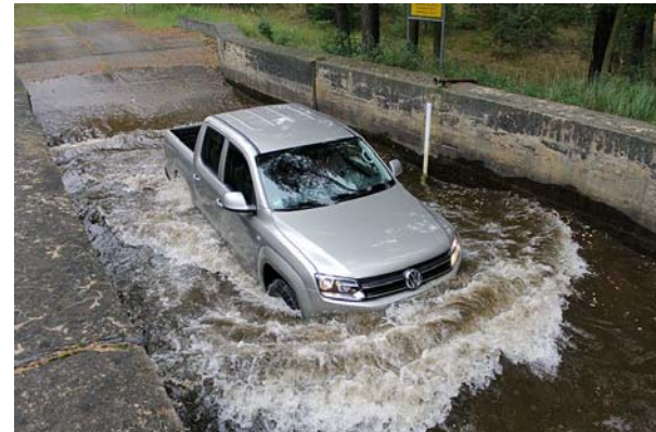
F28: Alle Leuchteinheiten sind dicht, die Türen laufen allerdings voll Wasser.
