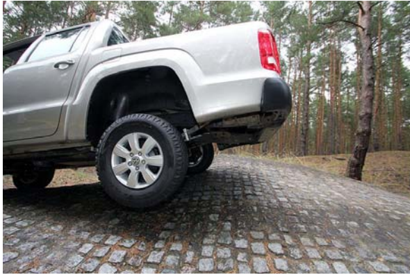
F7: Die Hinterachse federt weit aus, auch die Einzelradaufhängung vorne trägt einiges zur guten Verschränkung bei.
