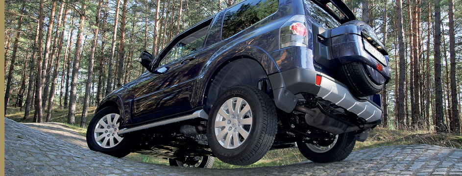
MACHT ALLES Mit dem kurzen Radstand von nur 2,55 Metern krabbelt der Pajero flink wie ein Wiesel über die Verschränkungsbahn. Deutlich am linken Hinterrad zu sehen: der große Federweg
