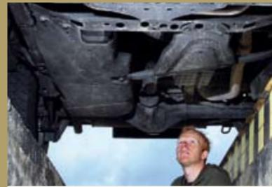
Das riesenhafte Schutzblech unter dem Getriebe, mit dem die YJ-Wrangler mächtig im Boden schürften, ist Geschichte. Aus dem Unterboden ragen lediglich die Differentiale heraus, der Rest
