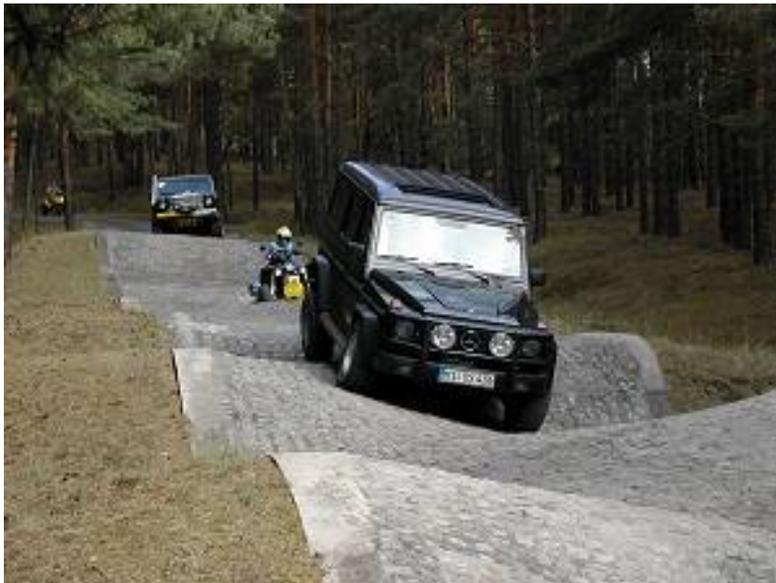
Auch die Verwindungsbahn sollte mit Respekt angegangen werden. Wird zu weit von der Mitte der Bahn seitlich abgewichen, kann die Amplitude zwischen den gegenläufigen Wellen vom Fahrwerk nicht mehr kompensiert werden.
