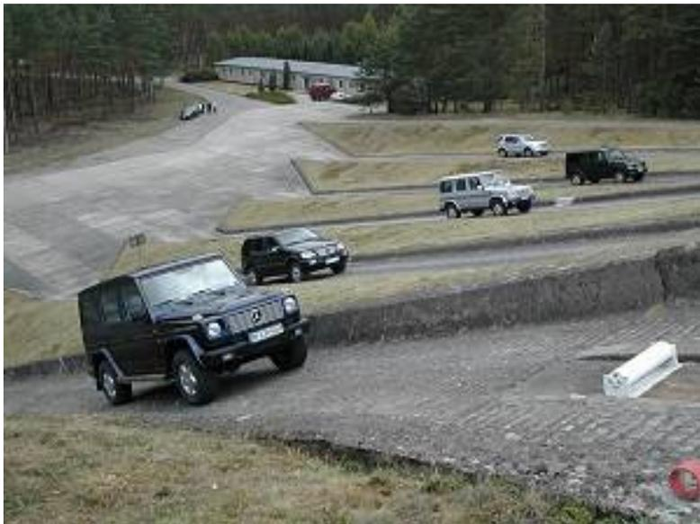
Die klassischen Module der Off-Road-Strecke: In den Steigungsbahnen (v.l.n.r.) 35 %, 30 %, 25 % und 20 %. Ganz außen, ohne Fahrzeug, die 15 %-Bahn, an diesen Tagen eine normale Straße für den rückfließenden Verkehr.
