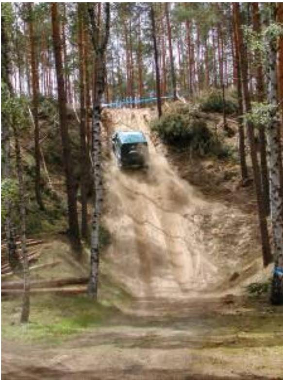
Der lose Sandhang mit etwa 45 % Steigung war eine echte Herausforderung. Voraussetzung für ein "Gipfelglück" waren u.a. Geländebereifung mit etwas vermindertem Druck, erster Gang, allen Sperren aktiv (Verteilgetriebe und jeweils in den Achsgetrieben) und natürlich Drehmoment satt, z. B. 400 Nm (2,7 l Diesel, 115 KW/156 PS bei etwa 2200 U/min).
