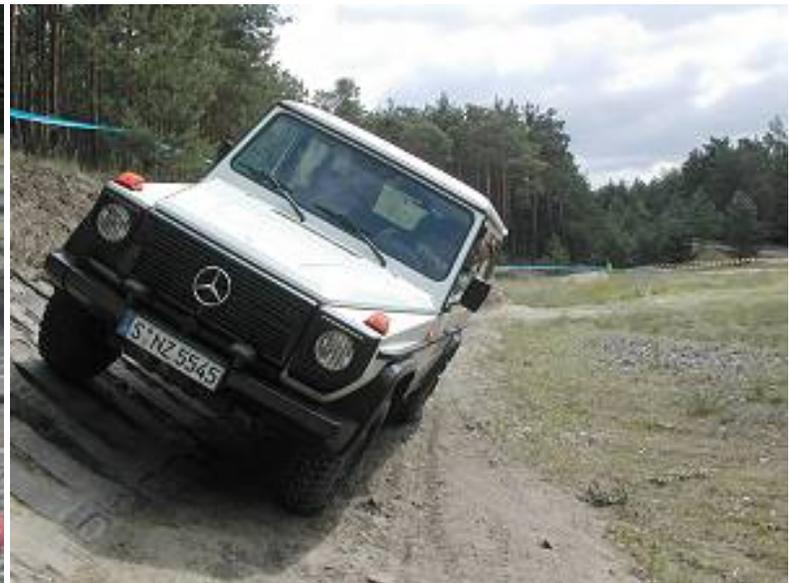
Schrägfahrt mit dem "G" bis 38 ° kein Problem. Sitzt der Fahrer unten, ist der subjektive Eindruck dramatischer, die Hangneigung wird überschätzt. Umgekehrt, wenn der Fahrer auf der Hangseite, d.h. oben sitzt, würden Fahrzeuge öfter auf die Seite gekippt werden.
