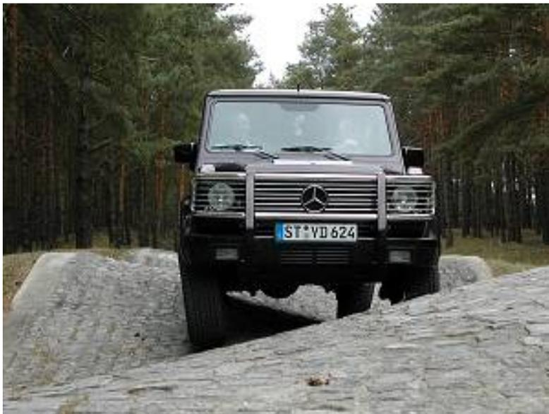
Die Verwindungsbahn wurde für Nutzfahrzeuge konzipiert. Diese fahren entsprechend der Radgröße eine äußere Spur. Die gekreuzten Achsen zeigen hier aber bereits bei einer "inneren" Fahrt die enorme Verwindung an.
